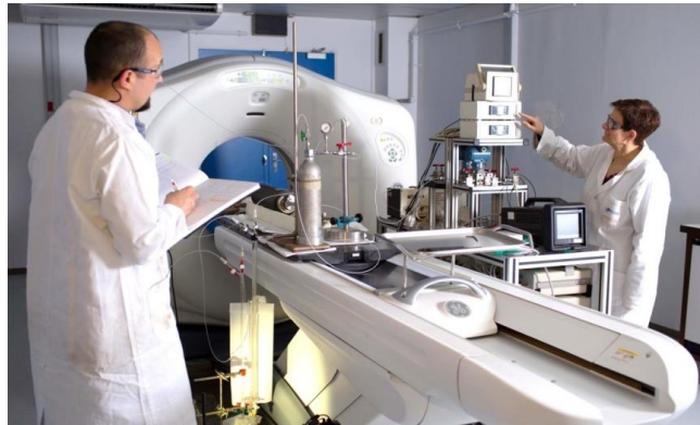
Expérience d'écoulement sous scanner X en laboratoire d'une mousse en écoulement dans un milieu poreux 3D
